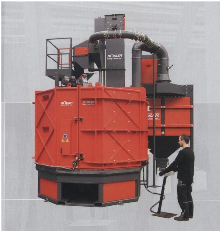
Дробемётная установка предназначена для очистки поверхности деталей после термообработки, подготовке поверхности к дальнейшим операциям (механическая обработка, гальваническое покрытие, покраска и т.п.), а так же для дробенаклепа.
