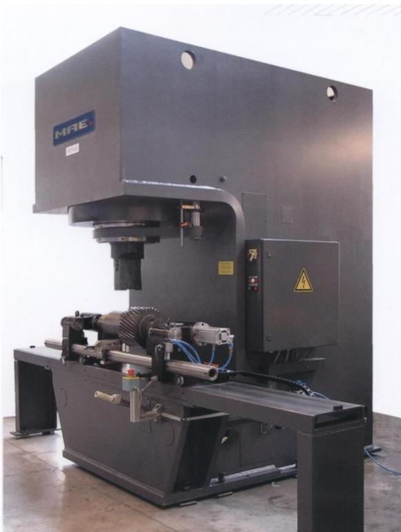
Применяется для правки деталей с целью снижения затрат после термической обработки на окончательную механическую обработку. Тип деталей: вал, ось, шток и т. п.
