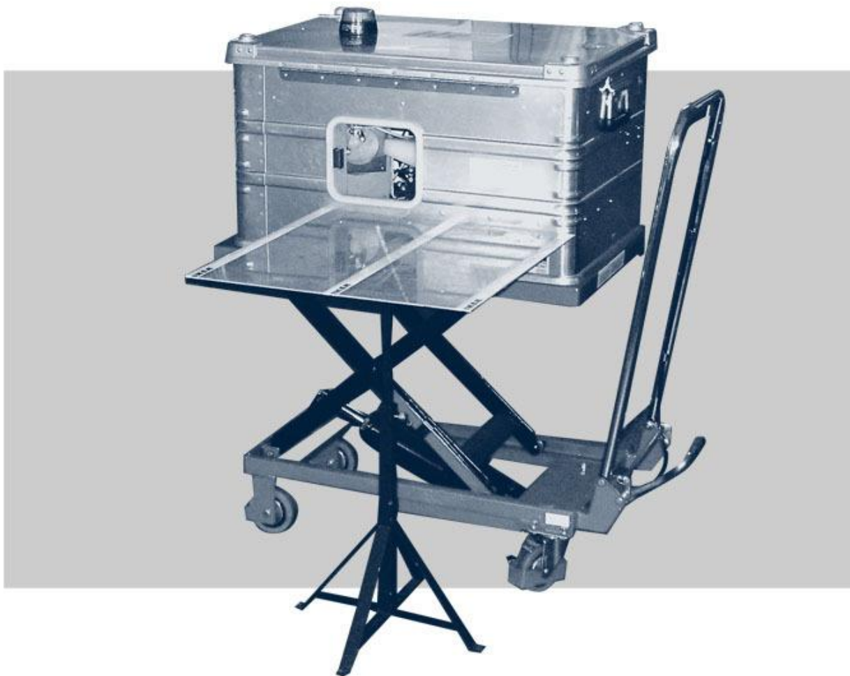
Рис. Переносной комплекс ДВИН-1 на основе технологии меченых нейтронов для обнаружения взрывчатых веществ.
