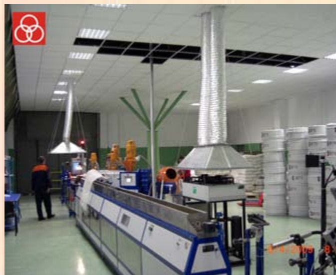
Автоматизированная экструзионная линия для производства композитных металлопластиковых труб диаметром 16...32 мм разработки и производства ООО «Экструзионные машины»
