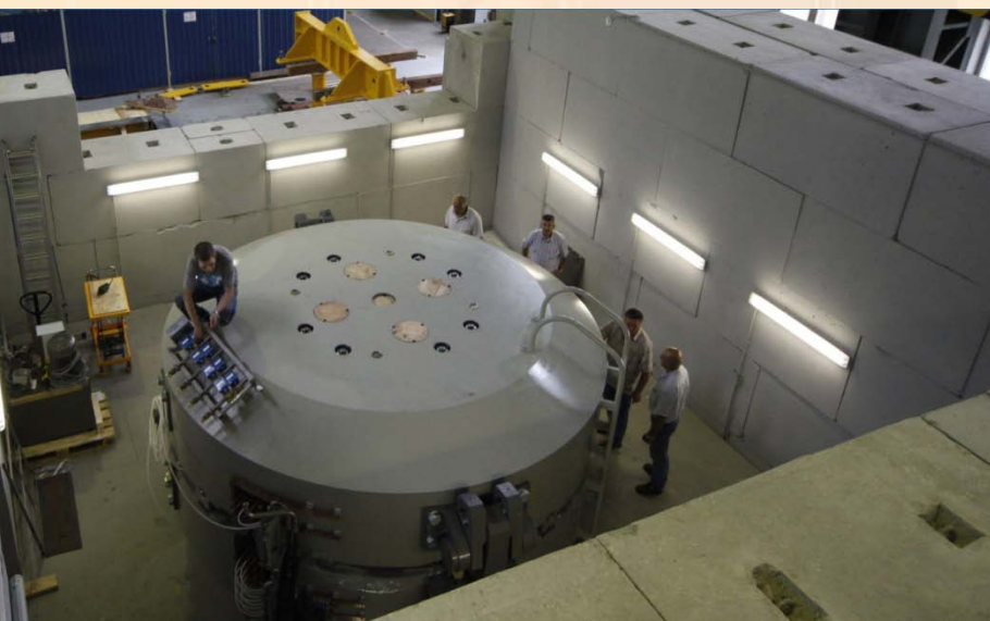
Сборка на площадке ОИЯИ циклотрона С 232 V3 для Димитровградского центра высоких медицинских технологий. Коллаборация IBA SA, ОИЯИ
