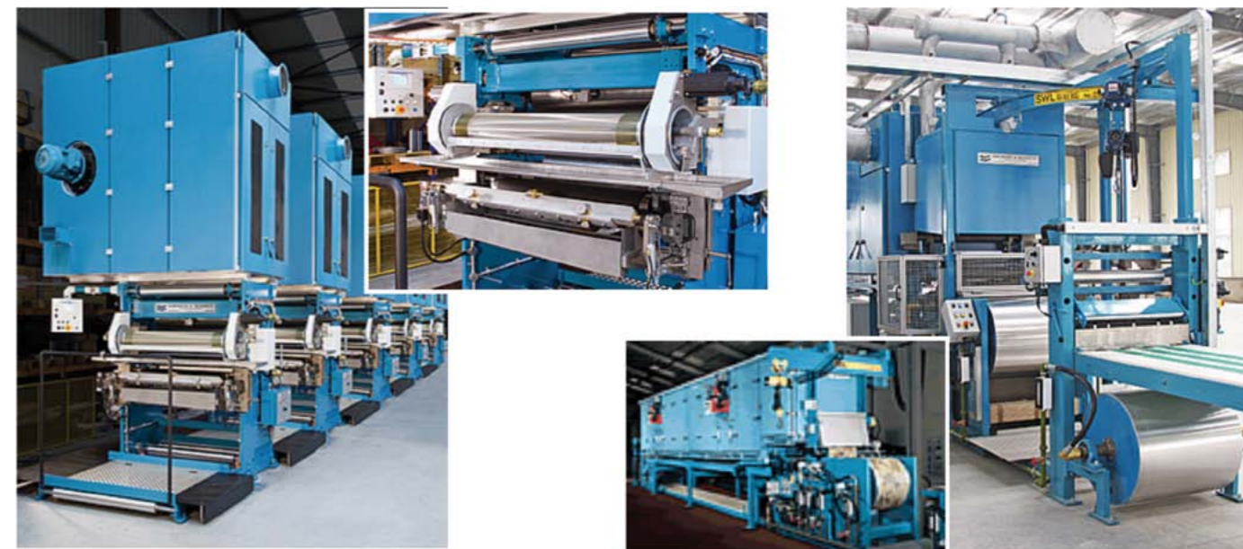
Линии трафаретной и комбинированной печати (трафарет + глубокая) Оборудованы головкой трафаретной печати 'infinity'
