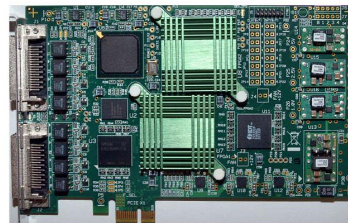
Рис. 5. Модуль приемников потоков ЕЗ/ТЗ (32 канала) на шине PCI-E
