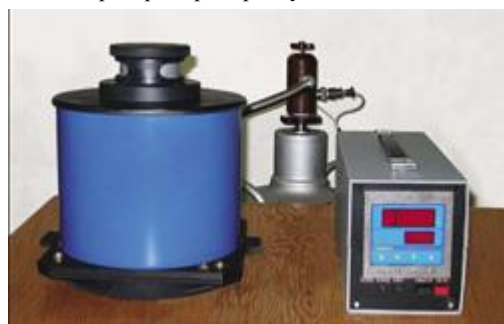
Микрокамера для испытаний малогабаритных изделий на воздействие повышенных и пониженных температур КТХ-0,001-05
