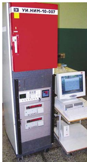
Установка для ускоренных испытаний на безотказность БИС УИ.НИМ-10-007М
