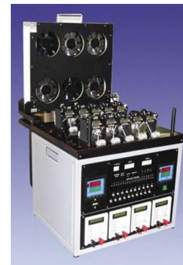
Стенд для испытаний на устойчивость к энергоциклам мощных транзисторов СИЭЦ-Т-001
