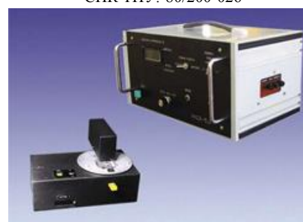
Установка для испытаний ИС на чувствительность к разряду статического электричества СИСЭ
