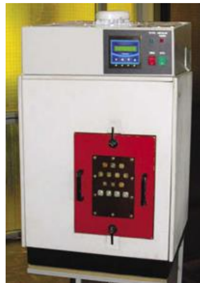
Испытательная камера «тепло-холод» с прецизионными температурными режимами СИК ТПУ.-80/200-026
